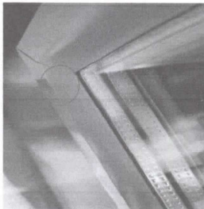
Figura 5. Fotografia do perfil de alumínio da porta de vidro da amostra da câmara de refrigeração científica da Benzer.
